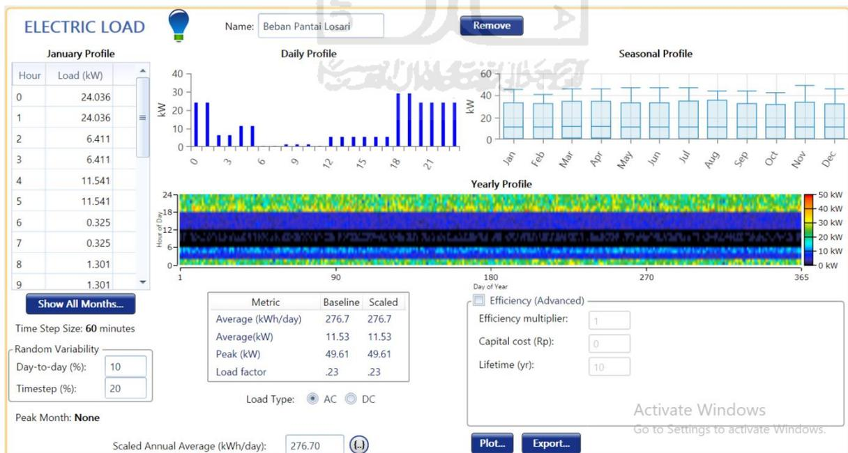
Gambar 3.9 Data Beban Pantai Losari pada HOMER
