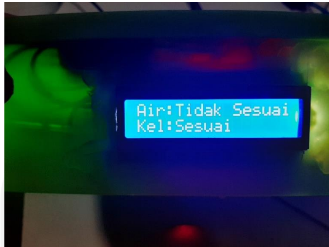
Gambar 4.10 Tampilan Kondisi Ketinggian Air dan Kelembaban Tanah Pada LCD
