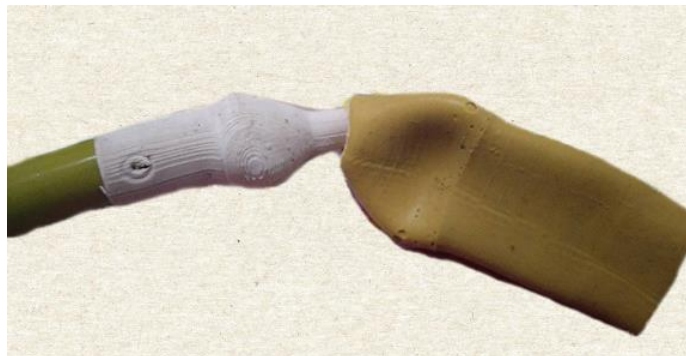
Gambar 4-12. Instalasi kulit sintetis.
