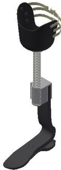
Gambar 2-3 Perancangan prostesis kaki palsu adjustable oleh Ari Setiadi Sumber: Suryawan et al., 2019
