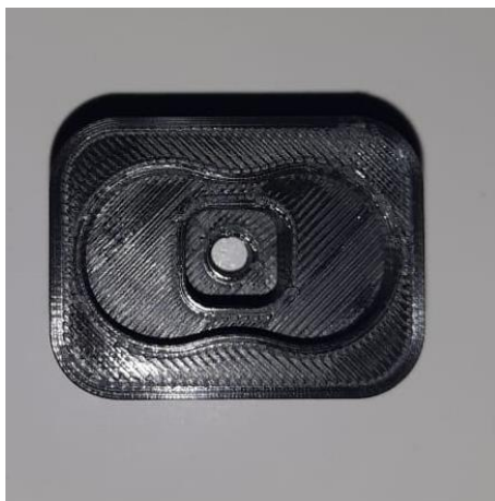
Gambar 4-103 Konektor 2 (sambungan ke shank )
