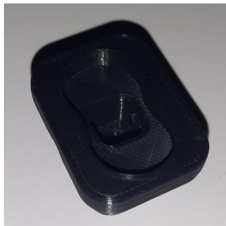
Gambar 4-103 Konektor 2 (sambungan ke shank )
