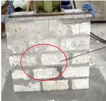
Penggunaan material batu kumbang yang mempunyai ukuran kurang presisi pada variasi dinding 1:6, membutuhkan mortar lebih banyak untuk dapat mengisi ruang diantara spesi antar batu.
