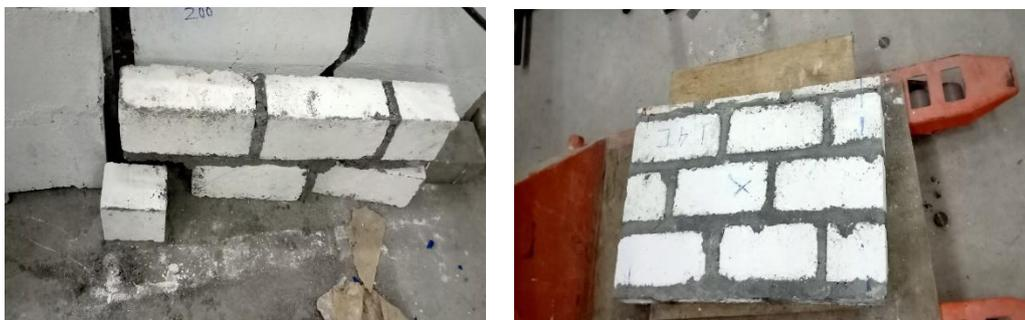
**Gambar 5.28 Benda Uji 1:4-C yang Mengalami *Crack* atau Lepas Sambungan**
