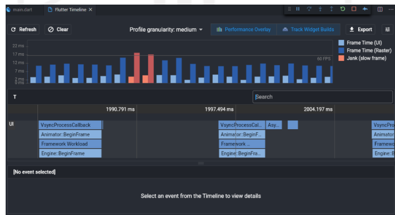
Gambar 3.8 DevTools Pengukuran FPS pada Flutt
