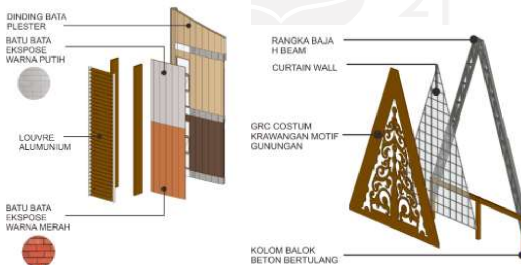
Gambar 72 Detail Selubung Bangunan 2
