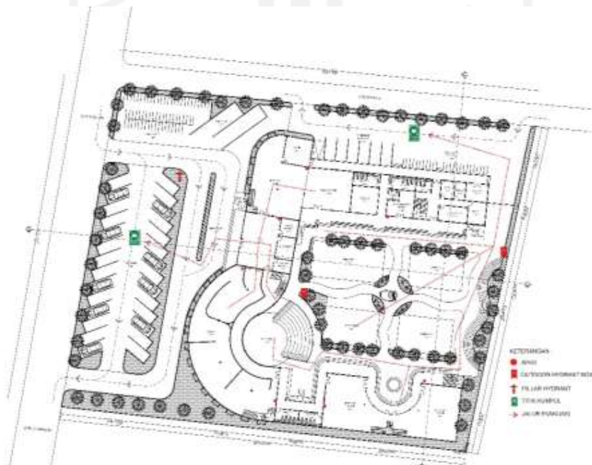
Gambar 96 Sistem Keselamatan Bangunan
