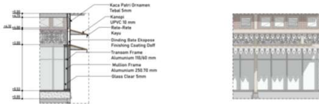
Gambar 5.17.2 Detail Selubung Bangunan Showroom
