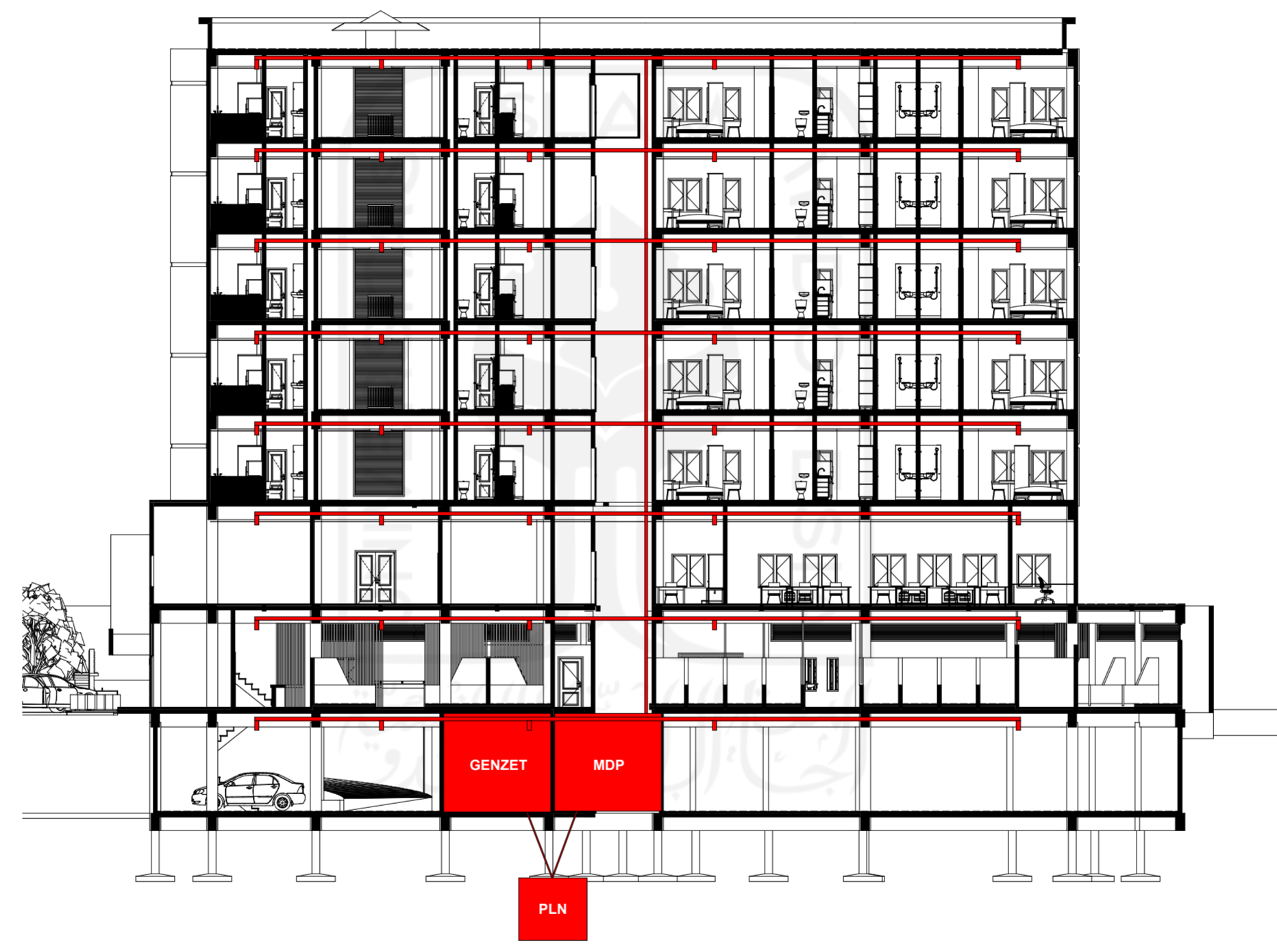
SKEMA POTONGAN BANGUNAN JARINGAN LISTRIK 1:200
