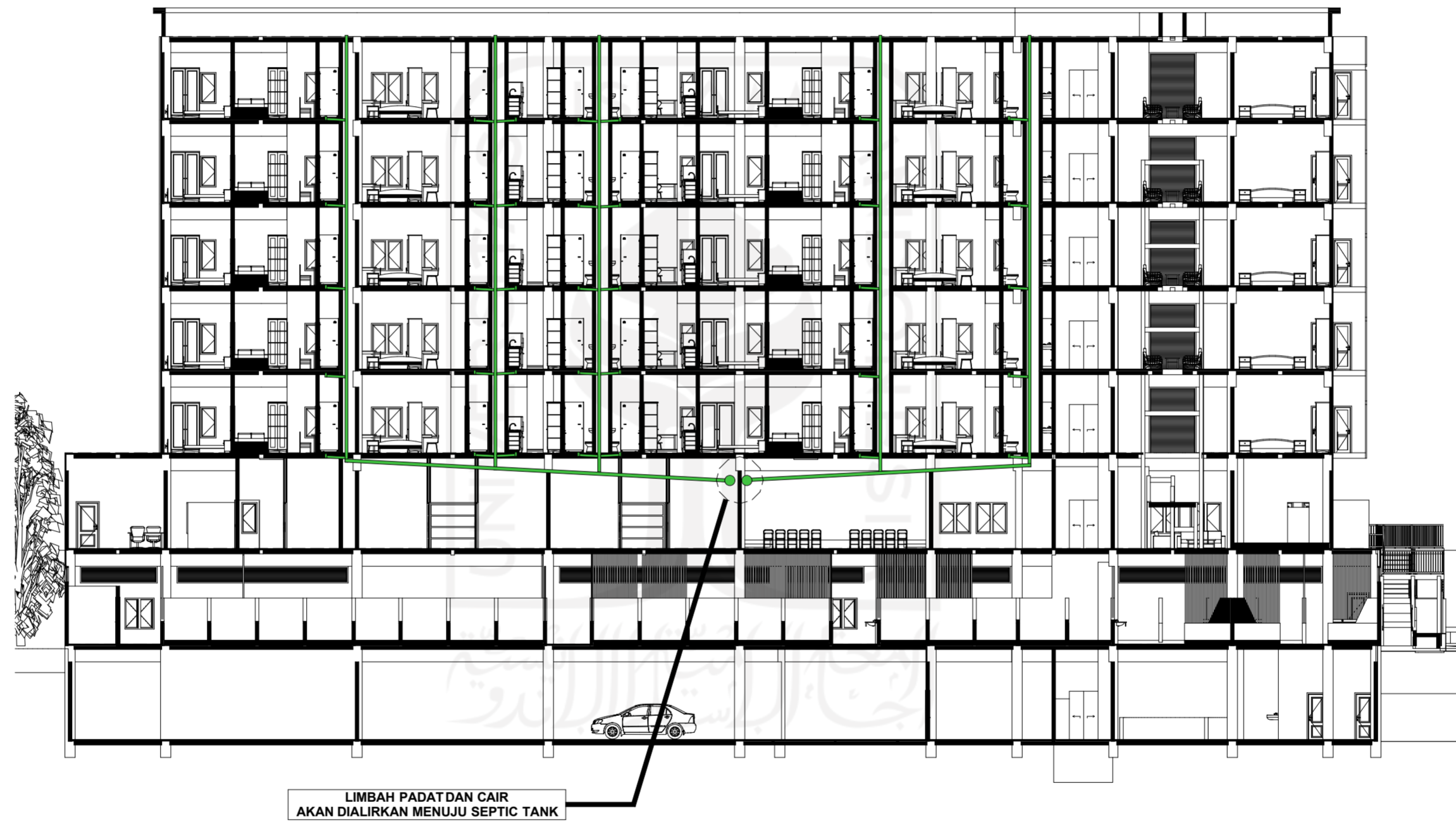
SKEMA POTONGAN BANGUNAN JARINGAN AIR KOTOR 1:200
