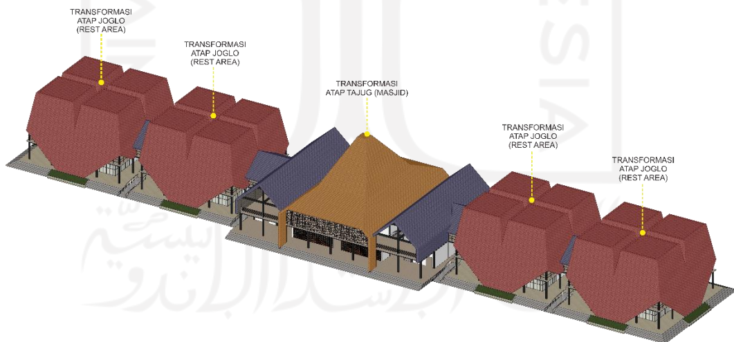
Gambar 3.27 Penerapan dan Integrasi Atap Tradisional pada Bangunan. Sumber: Penulis
