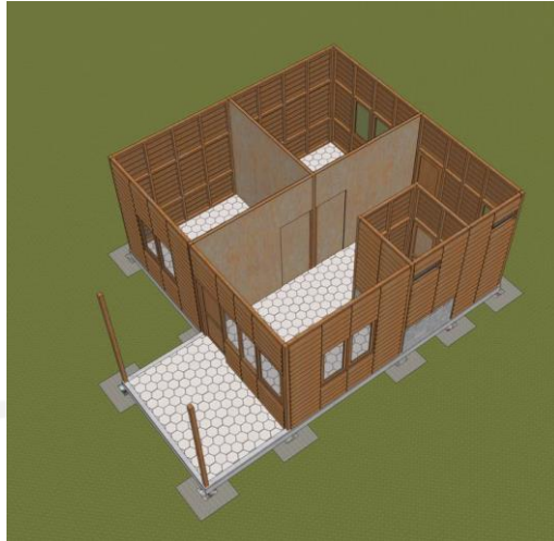
Gambar 5.34 Pekerjaan Dinding Huntara Tipe 36
