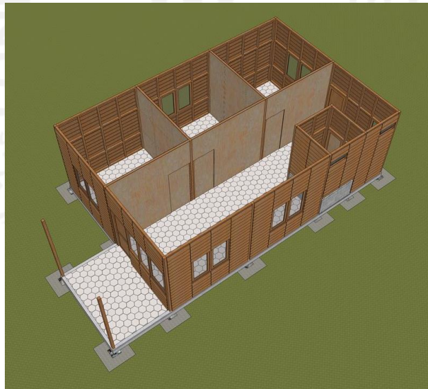
Gambar 5.28 Pekerjaan Dinding Huntara Tipe 54
