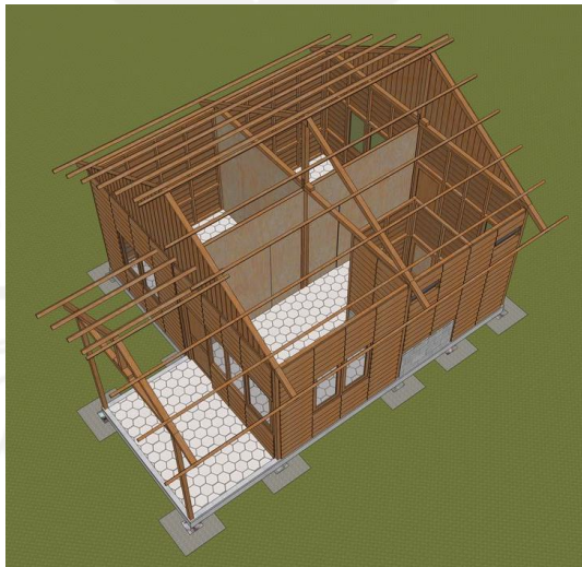
Gambar 5.35 Pekerjaan Rangka Atap Huntara Tipe 36
