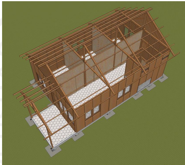
Gambar 5.29 Pekerjaan Rangka Huntara Tipe 54
