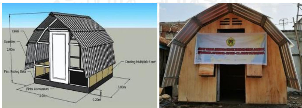
Gambar 2.2 Sketsa dan Prototipe Hunian Sementara Lumbung Spandek-Plywood
