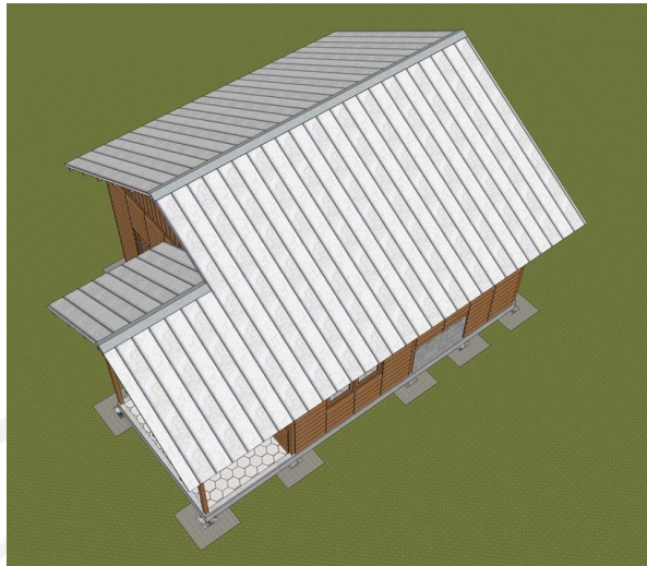
Gambar 5.36 Pekerjaan Atap Huntara Tipe 36
