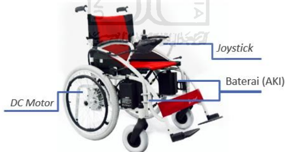
Gambar 3- 9 Komponen Yang Diambil Dari Kursi Roda Elektrik Biasa
