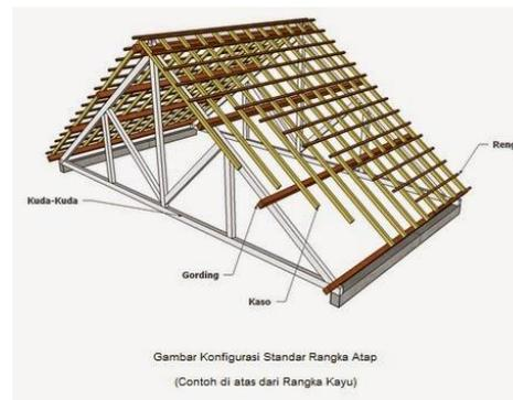
**Gambar 3. 3 Struktur Atap Rangka Kayu**
