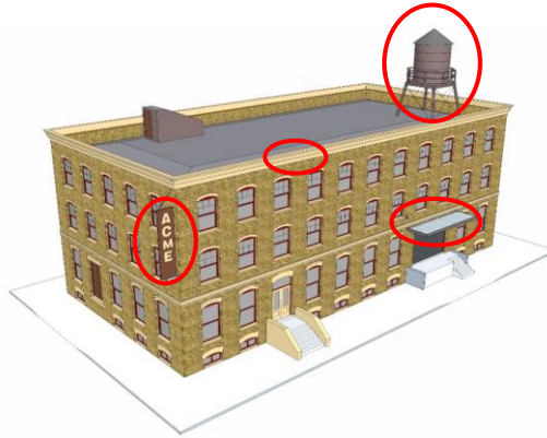
Gambar 3.26 Ilustrasi bangunan dengan potensi bahaya jatuh komponen eksterior.
