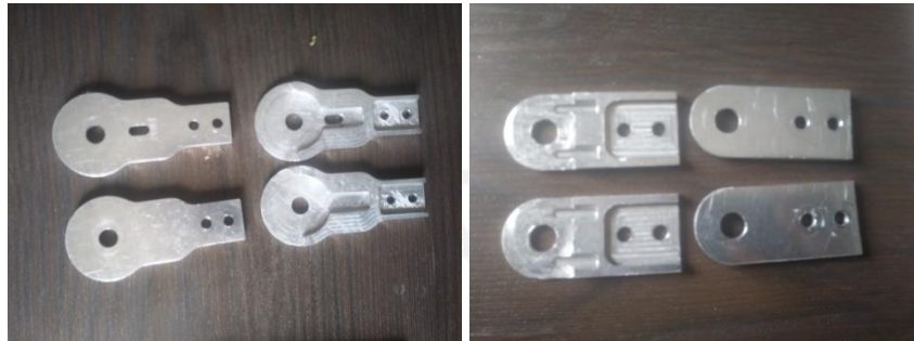
Gambar 4-14 Hasil pembuatan ankle joint dan knee joint
