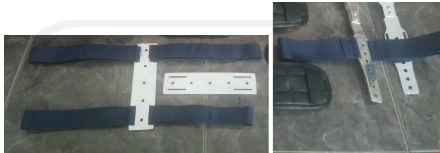
Gambar 4-16 Assembly pada belt dengan thigh dan shank tengah
