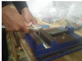
Gambar 4-11 Proses pembuatan ulir
