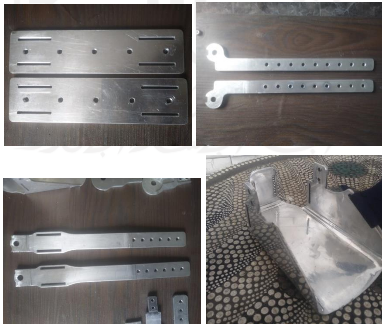
Gambar 4-13 hasil pembuatan Shank, Thigh dan Footplate
