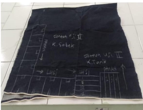
Gambar Kain Tenun Untuk Contoh Uji Kekuatan Tarik dan Kekuatan Sobek Kain
