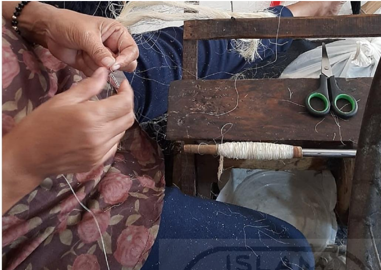
Gambar Menggulung Benang Sisal pada Bobbin Palet
