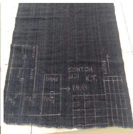
Gambar Kain Tenun Untuk Contoh Uji Kekuatan Tarik dan Kekuatan Sobek Kain
