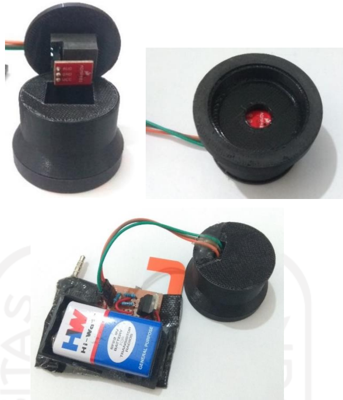
Gambar 4.2 Mikrofon ADMP401, catu daya 3,3 VDC dan Chest piece 3D printing
