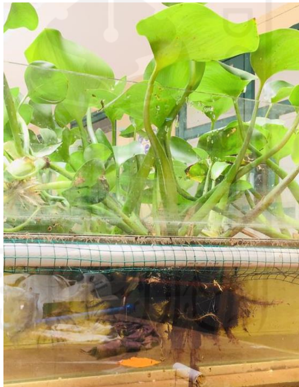
Gambar 34 Letak media Penyangga Polyurethane pada reaktor EFB+Sponge
