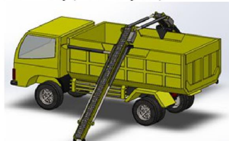
Alat Bantu Truck Loader Conveyor Saat Terbuka (Beroperasi)
