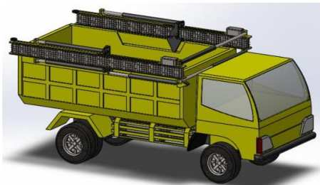
Alat Bantu Truck Loader Conveyor Saat Tertutup (Tidak Beroperasi)
