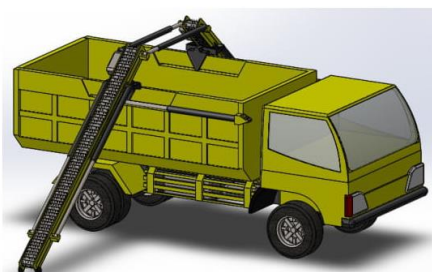
Alat Bantu Truck Loader Conveyor Saat Terbuka (Beroperasi)
