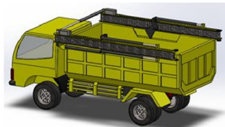
Alat Bantu Truck Loader Conveyor Saat Tertutup (Tidak Beroperasi)
