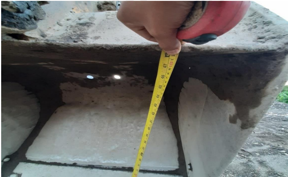
Gambar 5.5 Panjang 120 cm Bucket Komatsu PC-200 (Sumber: Dokumentasi Pribadi)
