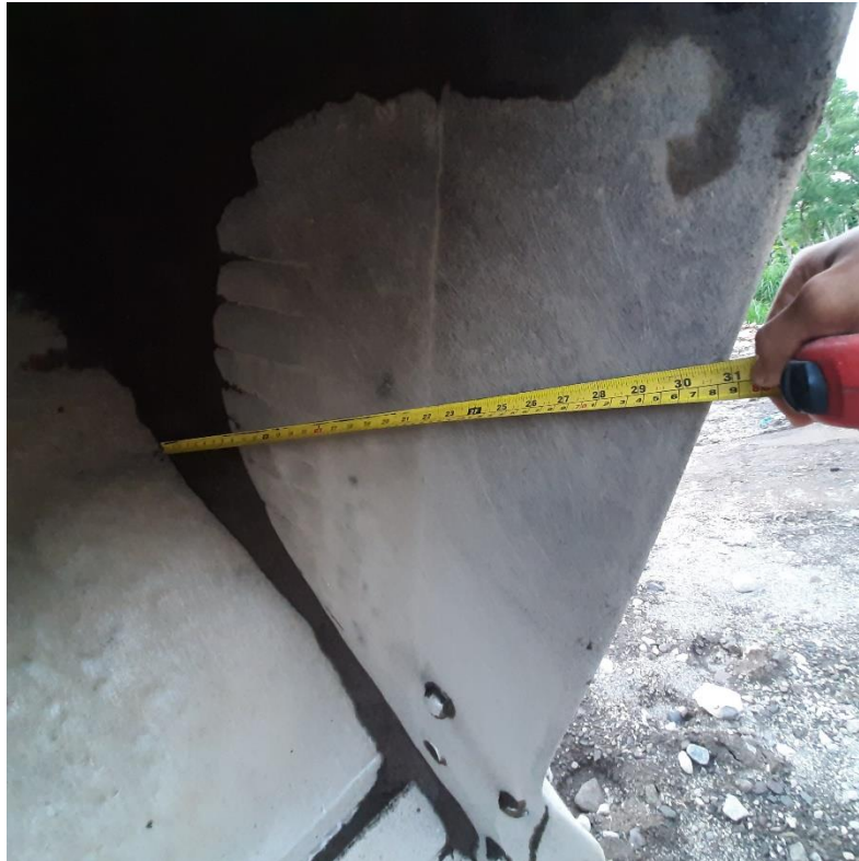
Gambar 5.6 Dalam 60 cm Bucket Komatsu PC-200
