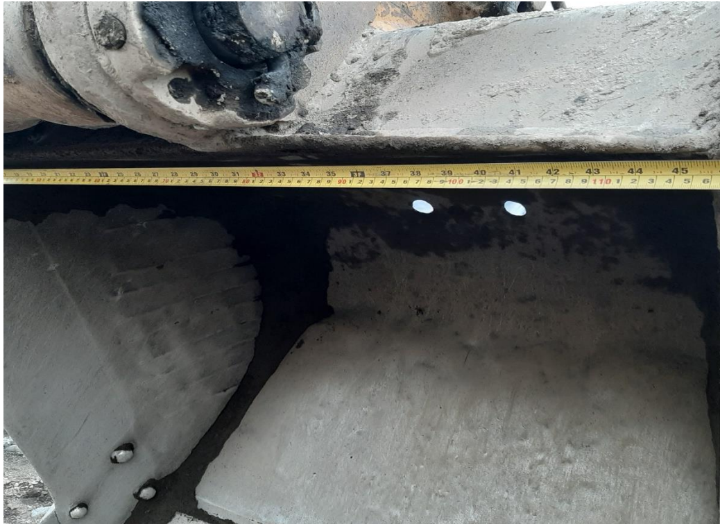
Gambar 5.4 Lebar 116cm Bucket Komatsu PC-200 (Sumber: Dokumentasi Pribadi)
