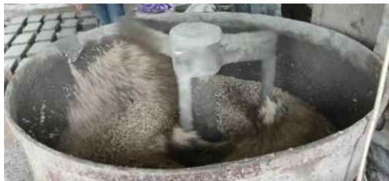
Gambar 4.2 Proses pengadukan campuran dengan Mixer Machine
