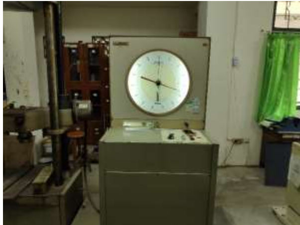
Gambar 4.6 Alat uji pembebanan maksimal pada batako
