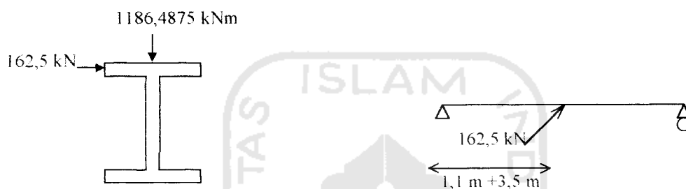
Gambar 5.37 Momen dan gaya rem Lenturan dua arah pada gelagar melintang
