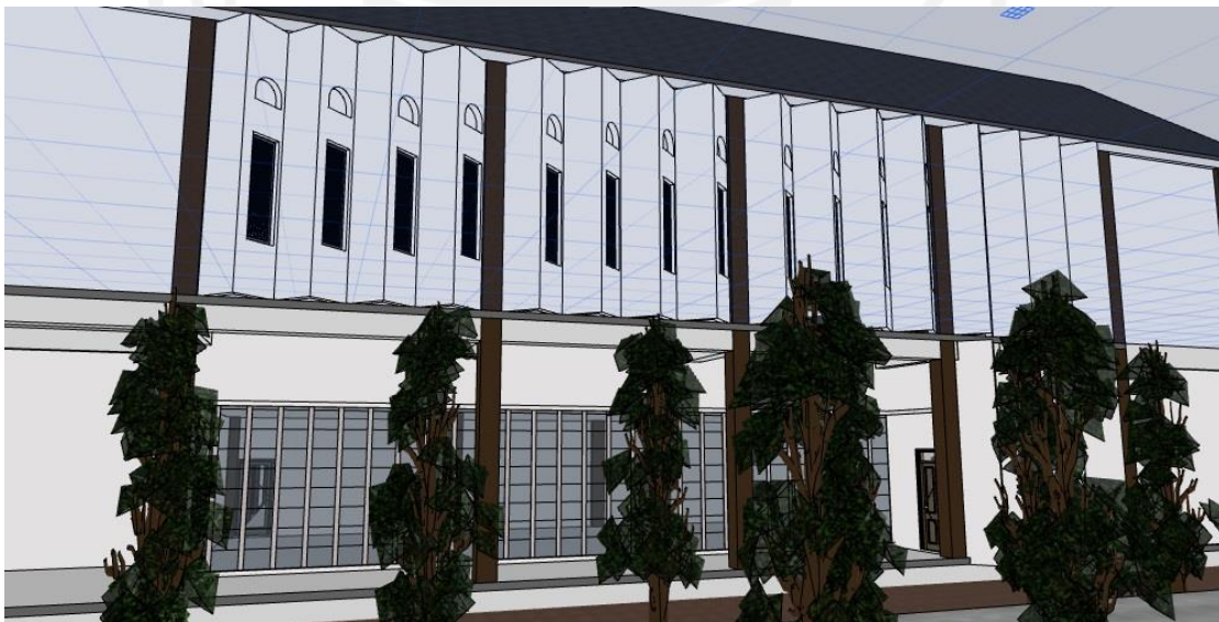
Gambar 4.34 Skematik Selubung Bangunan Ruang Workshop
