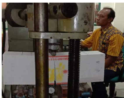
Gambar 5.4 Pengujian Kuat Lentur Bata Ringan
