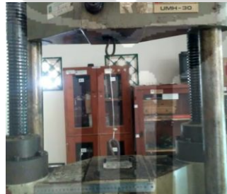
Gambar 5.12 Pengujian Tarik Kawat Galvanis
