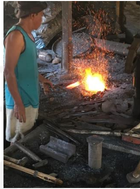
Gambar 5.11 Proses Pemanasan dan Pembakaran Plat Besi
