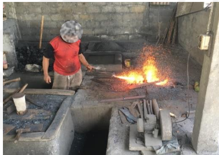
Gambar 5.4 Proses Pemanasan dan Pembakaran Plat Besi
