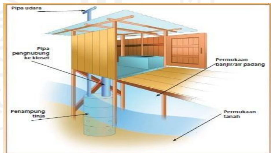
Gambar 21 Model Jamban Untuk Lingkungan Perairan Pasang Surut ( Water and Sanitation Program, 2009 )
