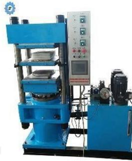
Gambar 2.4 Mesin press vulkanisir hidrolis karet. [7]
