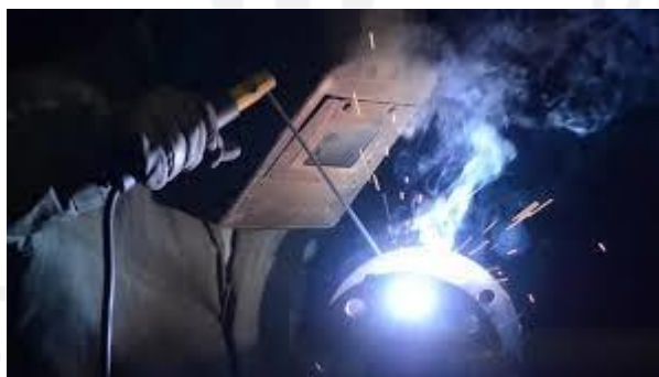
Gambar 2.1: Gambar las busur listrik
