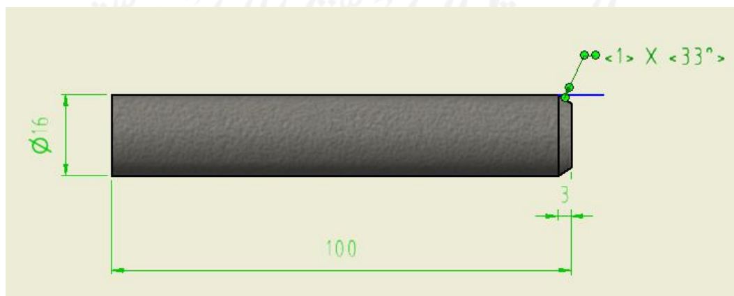
Gambar 3.5: Gambar Teknik sambungan cone
