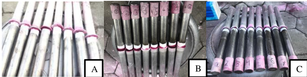
Gambar 4.6: Hasil pengujian Dye Penetrant (A) sambungan datar (B) sambungan fins (C) sambungan cone
