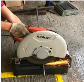
Gambar 3.2: Proses pemotongan spesimen
