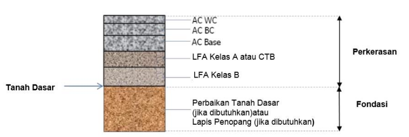
Gambar 3.5 Struktur Perkerasan Lentur Pada Permukaan Tanah Asli
