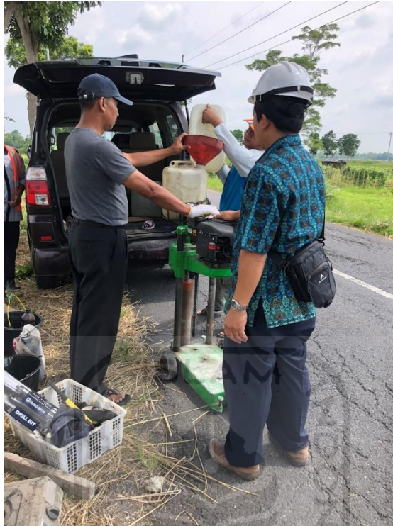
Gambar L – 6.1 Persiapan Alat Core Drill Pada Lokasi Penelitian
