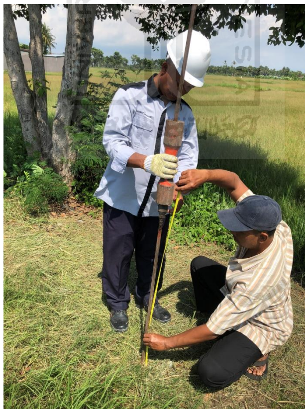
Gambar L – 6.4 Pengujian CBR Menggunakan Alat DCP
