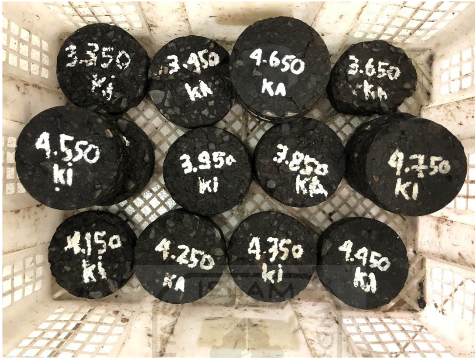
Gambar L – 6.7 Benda Uji Hasil Pengambilan Menggunakan Core Drill
