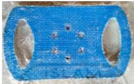
Gambar 4- 15 Serat gelas yang sudah mengering
