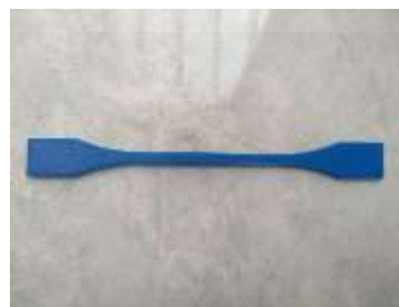
Gambar 3- 6 Hasil mencetak spesimen dengan mesin 3D Printing
