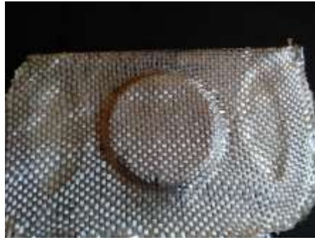
Gambar 4- 14 Proses penempelan serat gelas
