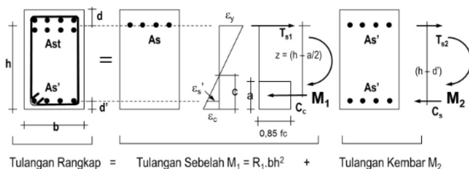
**Gambar 3.7 Dekomposisi Tulangan Rangkap pada Balok (Widodo, 2013)**
