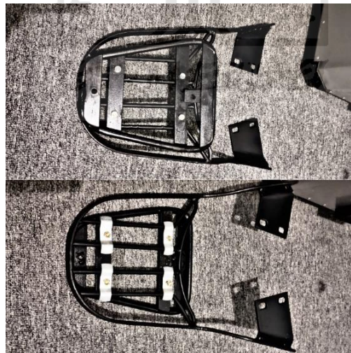
Gambar 5.5 Pemasangan plate base dan bracket
