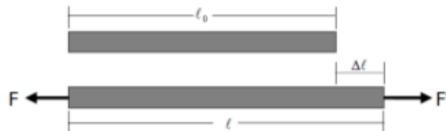
Gambar 2- 19 Perubahan panjang material ketika dikenai gaya
