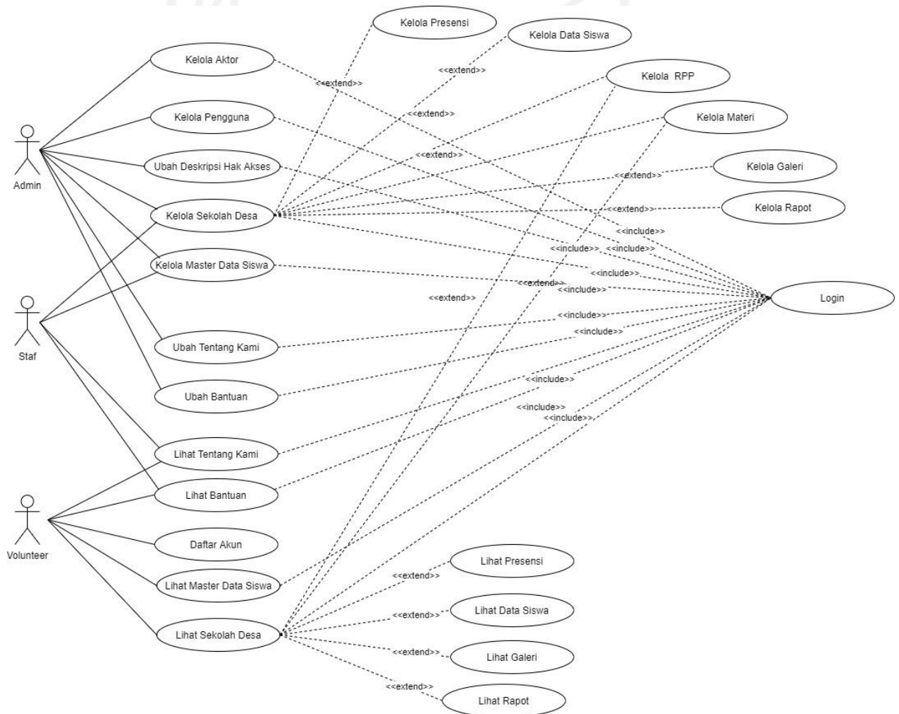
Gambar 3. 2 Use Case Diagram Sistem Informasi Pendataan Sekolah Desa Komunitas Pendar Foundation Yogyakarta
