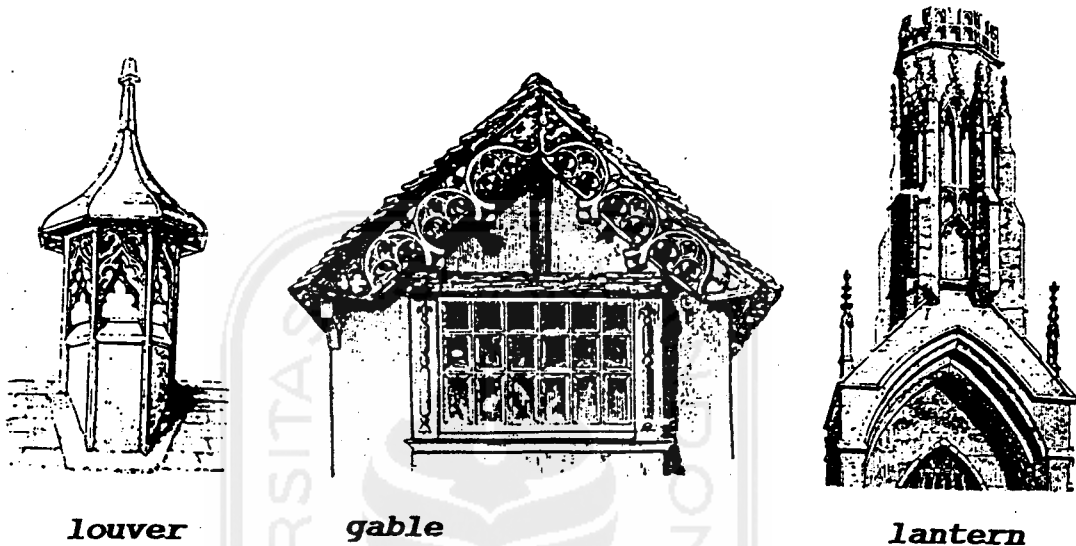
Gambar 4.34 Macam-macam Ornamen pada Bagian Atap Bangunan
