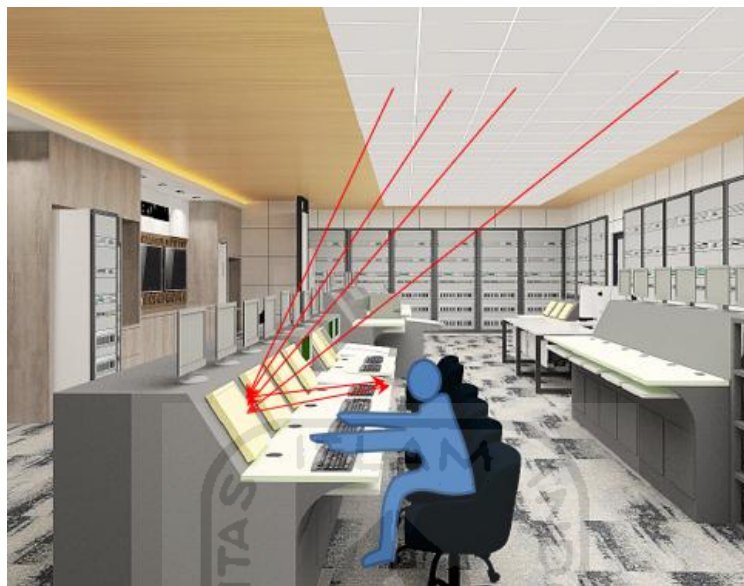
Gambar 4. 7 Ilustrasi Pantulan Lampu Penerangan Control Room Power Plant sebelum perbaikan
