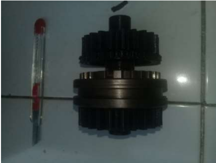
Gambar 4-23 Poros utama yang terpasang roda gigi.
