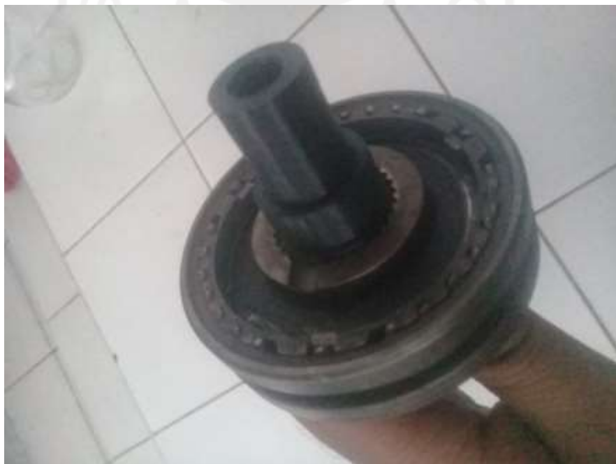
Gambar 4-22 Poros utama yang terpasang synchronesh .
