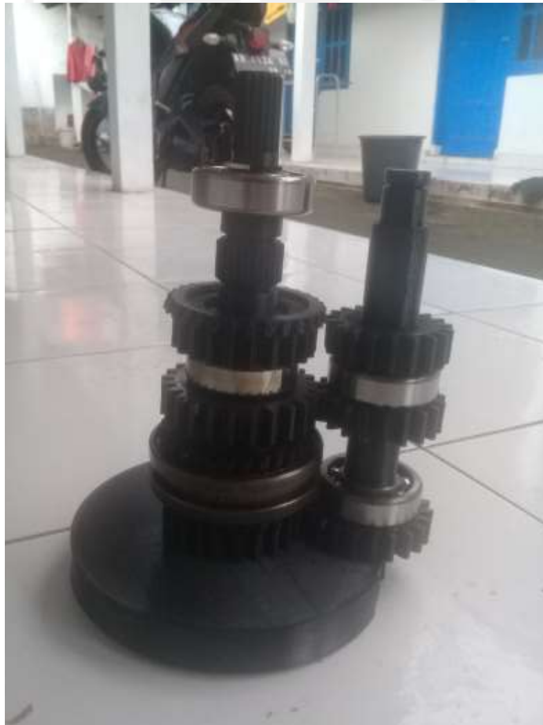
Gambar 4-23 Poros utama yang terpasang roda gigi.
