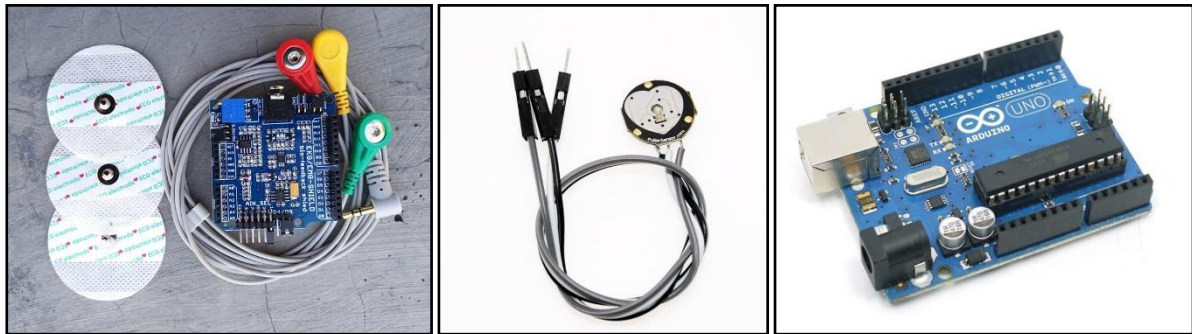
Gambar 3.3 Alat Rekam Data : EKG Shield (Kiri) [17] , Photoplethysmography (PPG) (Tengah) [18], dan Arduino Uno (Kanan) [19].
