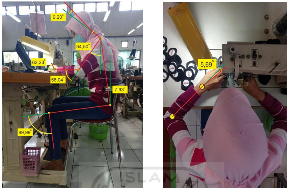
Gambar 4.17 Postur kerja karyawan jahit pita setelah perbaikan (Tampak samping dan tampak atas)
