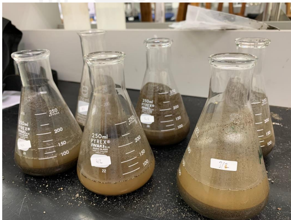
Gambar 3.6 Tahap memisahkan Residu dengan menambah NaCl jenuh
