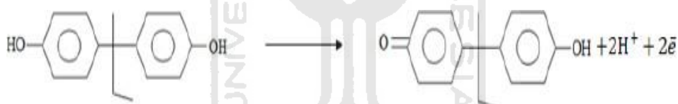
Gambar 4.5 Reaksi Elektrooksidasi dari Senyawa BispHenol-B
