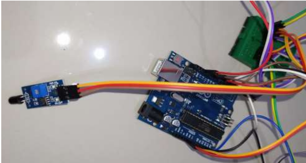
Gambar 3.5 Perancangan sensor api
