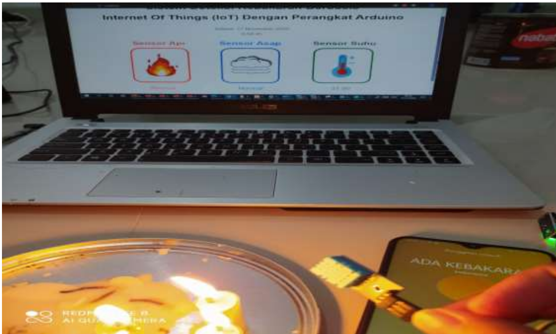
Gambar 4.15 pengujian sensor suhu
