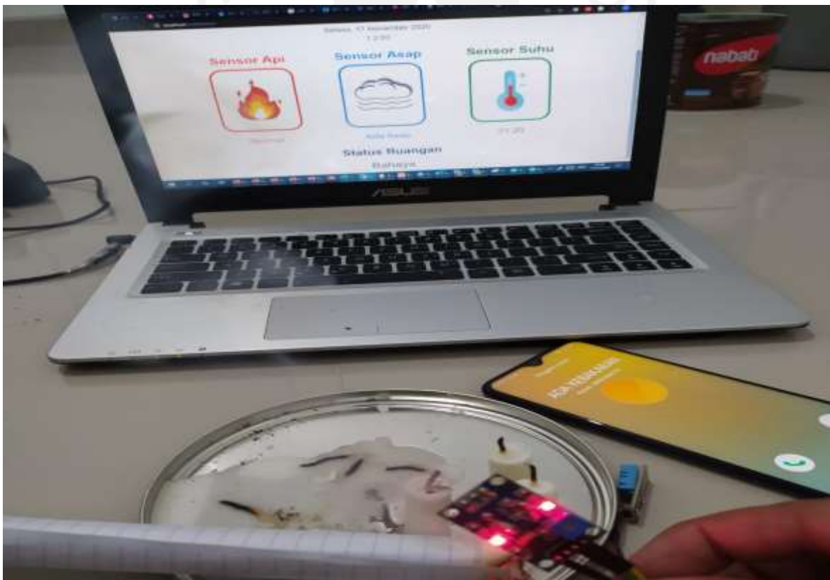
Gambar 4.13 Pengujian sensor asap
