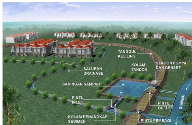
Gambar 2. 1 Desain Sistem Drainase Berwawasan Lingkungan (sumber : Permen PU Nomor 12 Tahun 2014)
