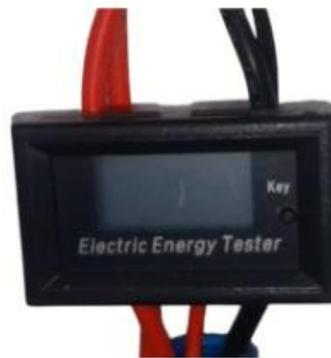
Gambar 3.6 Energi Meter Digital
