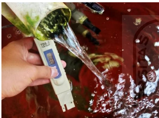
Gambar Pengujian 2 Otomatis 2300 PPM
