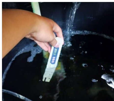
Gambar Pengujian 1 Manual 1670 PPM
