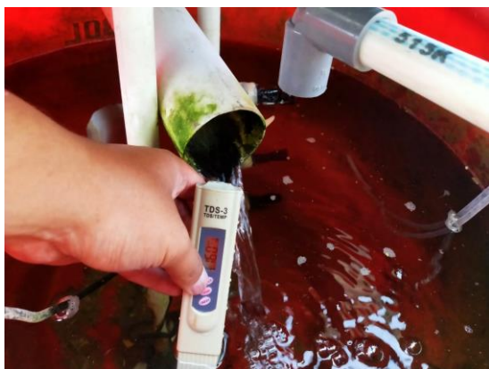
Gambar Pengujian 1 Otomatis 1600 PPM
