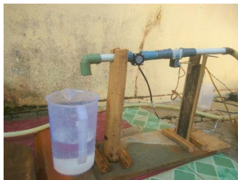
Gambar 4.2 Kalibrasi flow sensor dengan gelas ukur
