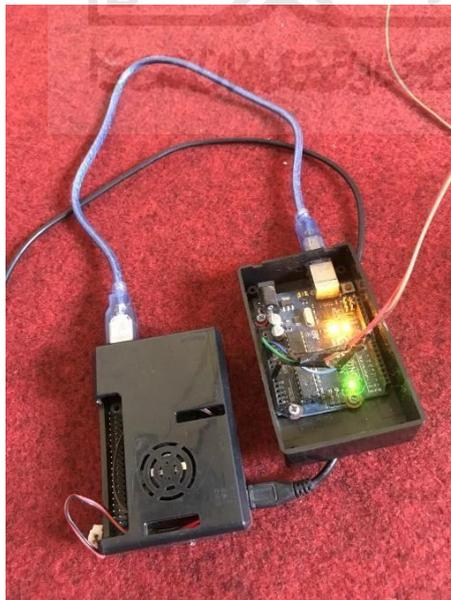
Gambar 4.1 Raspberry Pi Dengan Arduino
