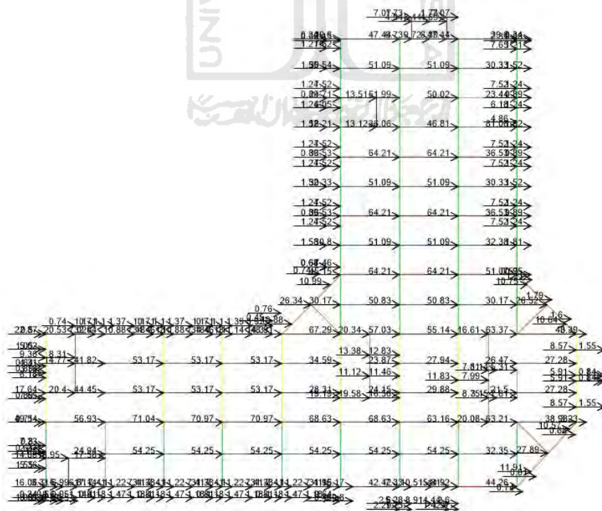
Gambar 5. 24 Gaya Joint Load Fpx Arah X pada Lantai 6
