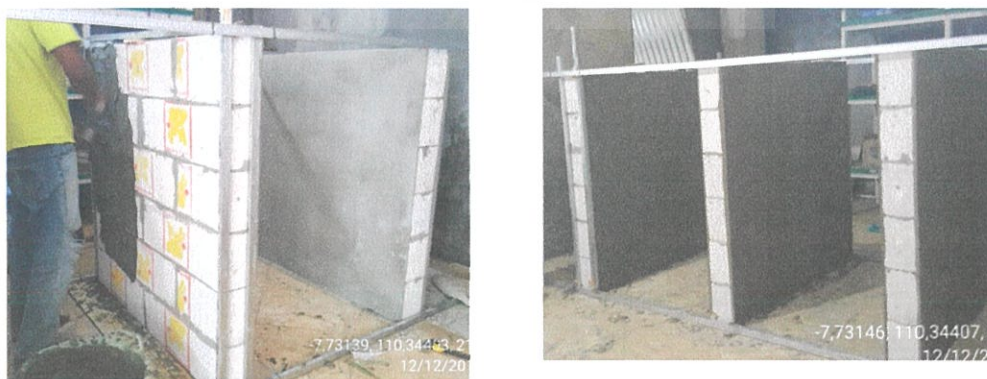
BENDA UJI DINDING BATA RINGAN PLESTER (DBRP)
