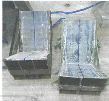
DUDUKAN SUDUT BENDA UJI
