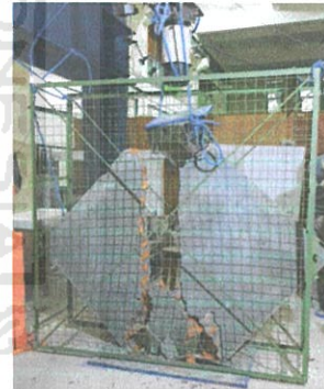
RETAK GESER BENDA UJI DBMP
