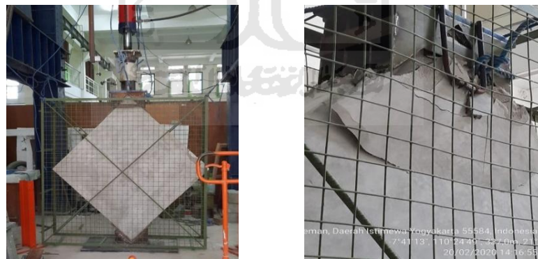
Gambar 5. 25 Uji Geser Dinding Pasangan Bata Ringan (DBR100)
