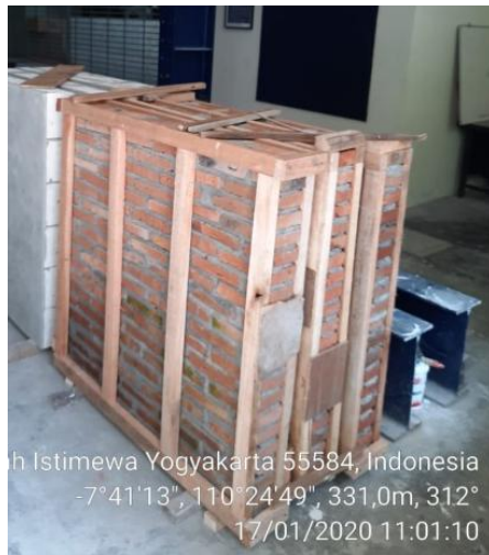
Gambar 4. 6 Paking Benda Uji dan Alat Angkat
