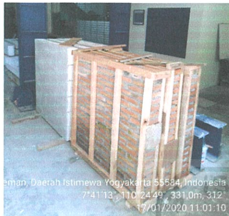
PAKING DAN PENGANGKATAN BENDA UJI DINDING BATA MERAH TANPA PLESTER (DBMTP)
