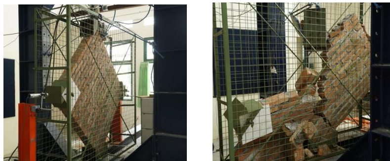
Gambar 5. 15 Uji Geser Dinding Bata Merah Tanpa Plester (BMTP)
