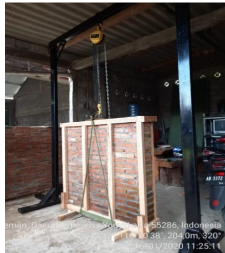
Gambar 4. 6 Paking Benda Uji dan Alat Angkat
