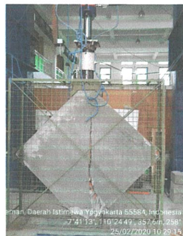
RETAK GESER BENDA UJI DBMP
