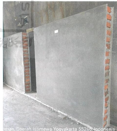
PEMBUATAN BENDA UJI DINDING BATA MERAH TANPA PLESTER (DBMTP)
