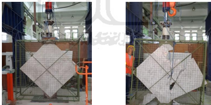
Gambar 5. 23 Uji Geser Dinding Pasangan Bata Ringan (DBR 75)
