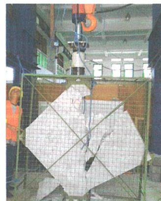
RETAK GESER BENDA UJI DBRP
