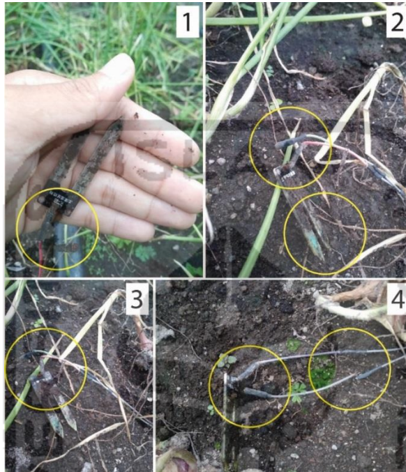
Gambar 4.2 Kerusakan sensor slot male patah (1 dan 3), jamur (2), dan kabel putus (4)
